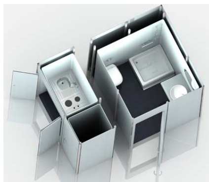
Abbildung: Modulare Systeme mit moderner Abwassertechnik für Nasszellen wie Toiletten und Duscbäder minimieren Eingriffe in die Bausubstanz.
